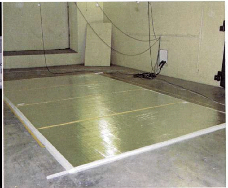
Foto 4: Montagem do item no piso da câmara reverberante.
